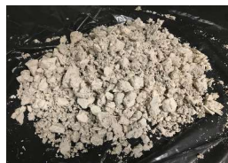
Figura 2. Enxofre elementar resultante do tratamento de biogás, Tratolixo.
