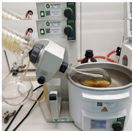
Figura 2. Recuperação do etanol em rotavapor.
