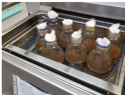
Figura 1. Fermentação do hidrolisado de palha em banho termostático com agitação.
