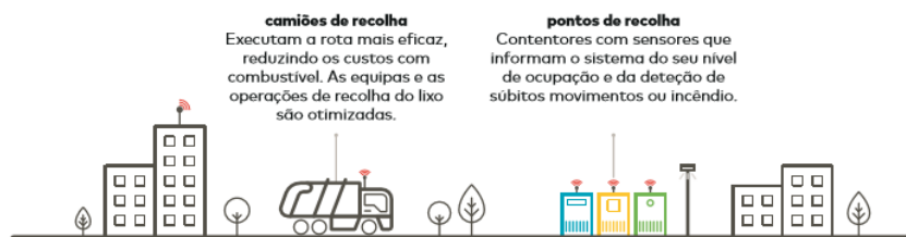
Figura 1. Arquitetura Exemplificativa do Sistema Smart Waste
