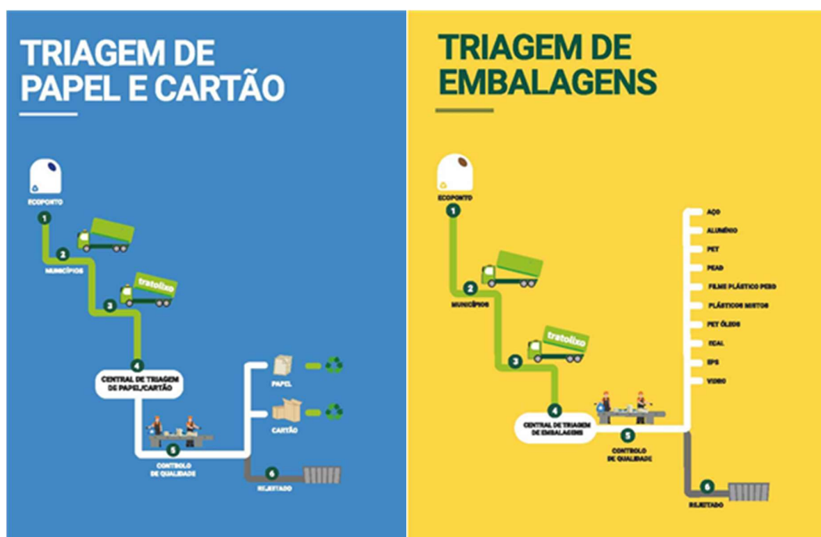
Representação esquemática do funcionamento da triagem de papel/cartão e embalagens de plástico, metal e ECAL na CT de Trajouce.
