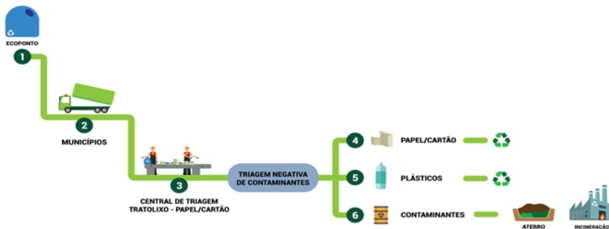
Figura 34 Representação esquemática do funcionamento da triagem de papel e cartão.
