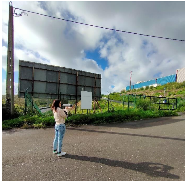
Figura 4 – Exemplo de medição com olfatómetro portátil Nasal Ranger
