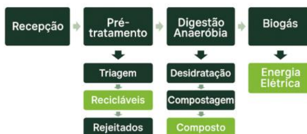
Figura 7 Esquema de funcionamento – Central de Digestão Anaeróbia
